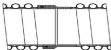
图 A.2 承插密封及电热熔双重连接方式
